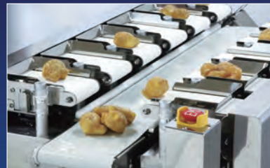
②定量パックの目標重量に最も近い被計量物の組合せを自動で排出します。
