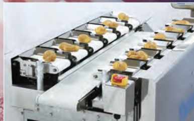
①計量コンベアの上に被計量物を載せます。
