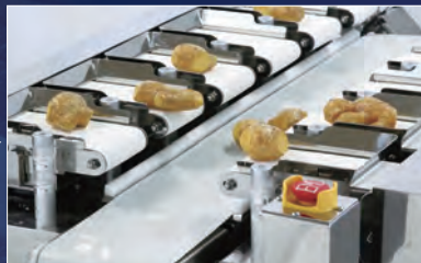
②定量パックの目標重量に最も近い被計量物の組合せを自動で排出します。
